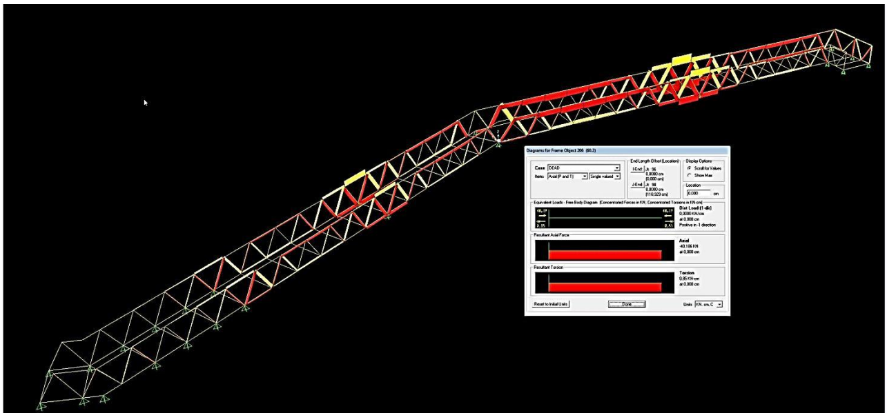
Axiles tras el análisis. La máxima compresión tiene un valor de 40 kN mientras que la sección donde aparece tiene más del doble de capacidad resistente
